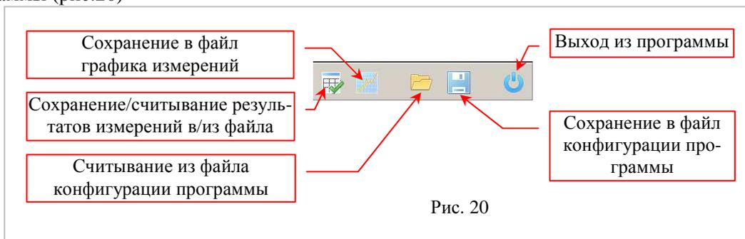
«Сохранение в файл графика измерений» - сохраняет в файл графическое изображение «графика результатов измерений». Формат файла – «jrg».
