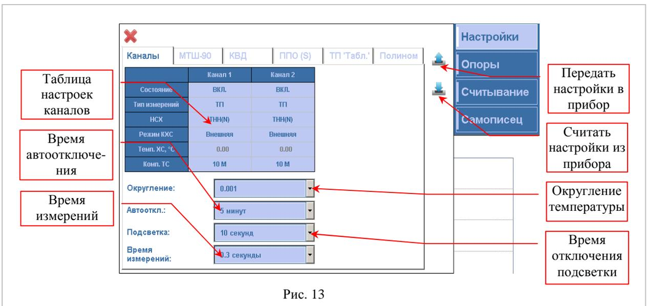
«Время измерений» - выбор времени измерений одного канала (0,3 с; 2,5 с; 2,5 с с цифровой фильтрацией).
