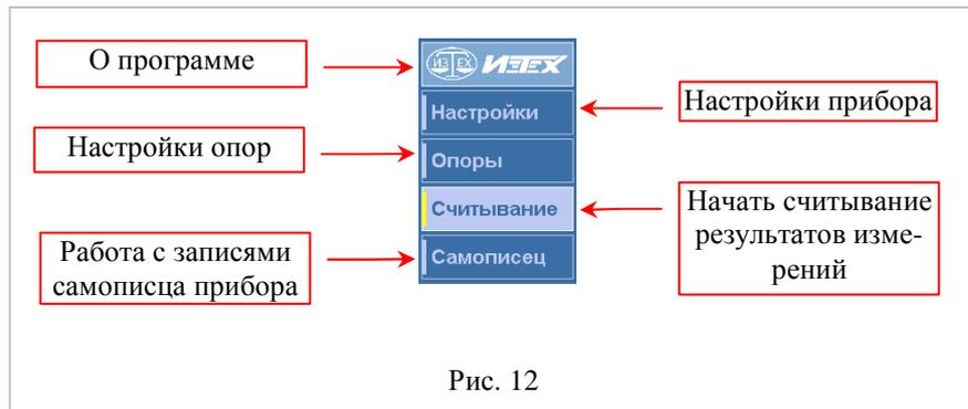
2.4.3.2 Нажатие кнопки «Настройки» открывает панель настроек прибора. На панели расположены 6 вкладок, а также кнопки передачи настроек в прибор и считывания настроек из прибора.
