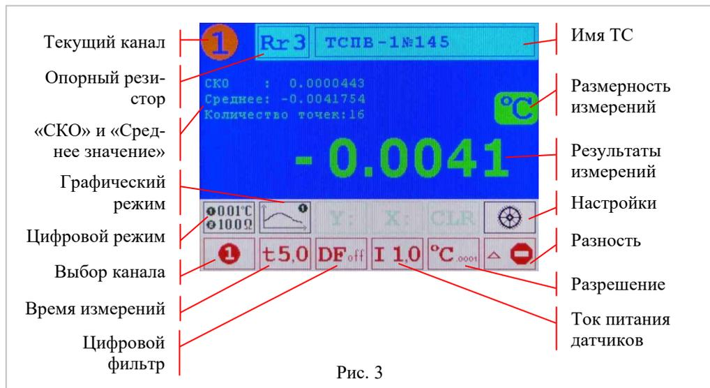
2.3.4 Нажатие на поле «Графический режим» переключает прибор в графический режим отображения результатов измерений. Рис. 4.
