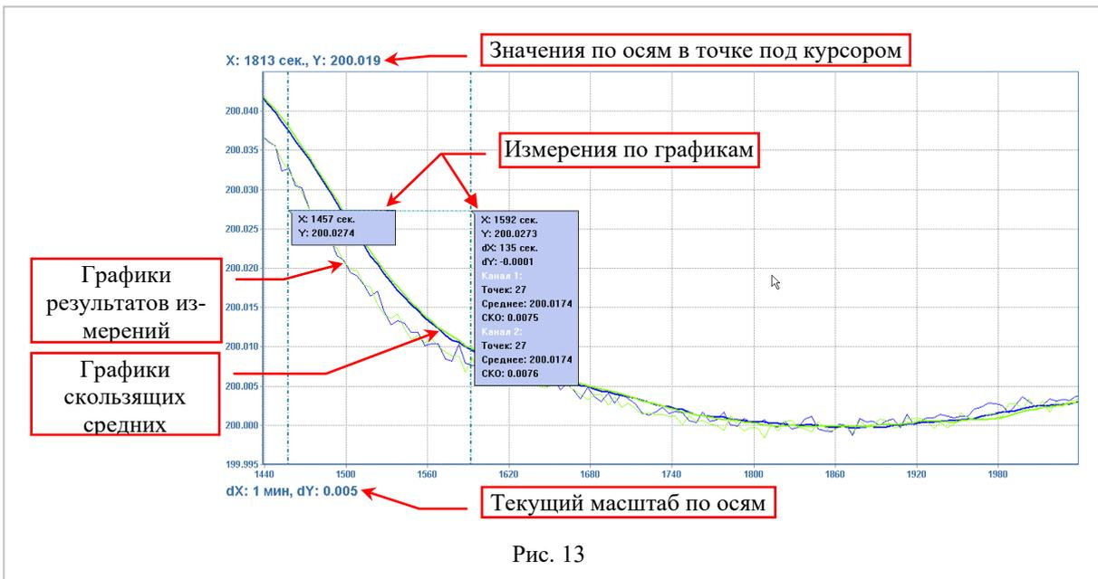
Результаты измерений прибором отображаются на графике.
