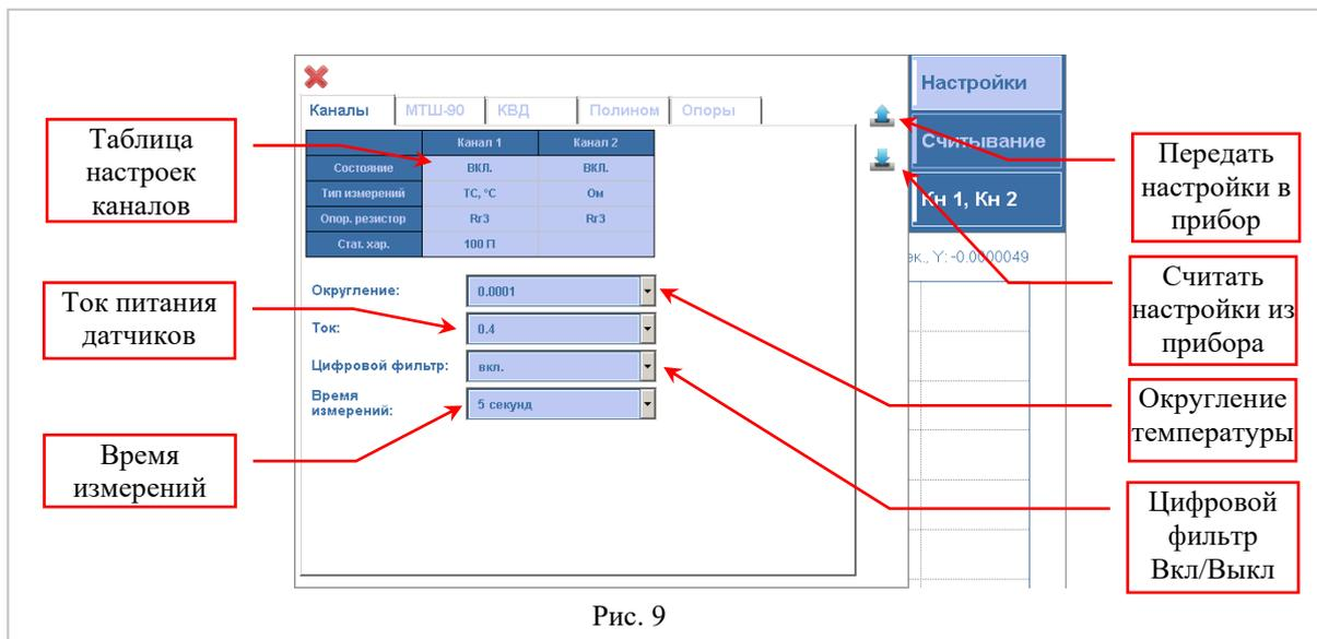
«Таблица настроек каналов» позволяет: включать/выключать каналы, задавать тип измерений (размерность) по аналогии с п.2.3.13, выбирать опорный резистор по аналогии с п.2.3.2 и выбирать статическую характеристику ТС по аналогии с п.2.3.14.
